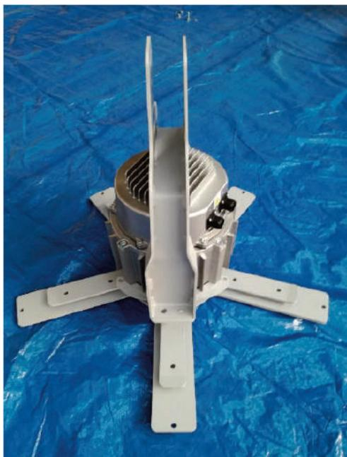
Introducir los tornillos correspondientes (mostrados a la izquierda) con la cabeza del tornillo hacia abajo y la tuerca en la parte superior, intercalados con las arandelas.
