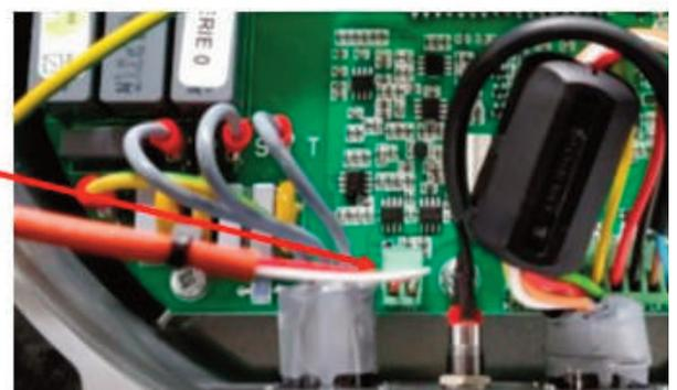
Desconectar los fastons de la electrónica del motor y de las fases de la sonda
