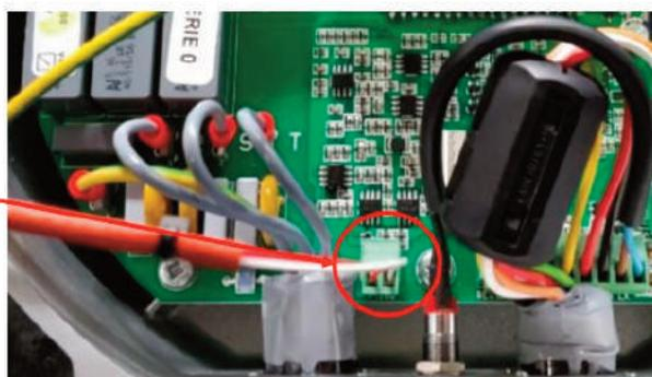
Insertar el conector verde, con cables Blanco/Rojo, del sensor de temperatura del motor en el correspondiente conector en la electrónica (colocado como se muestra en la imagen).
