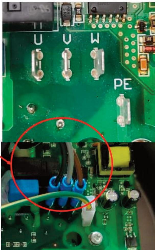
Insertar los faston en las fases del motor electrónico de acuerdo con el siguiente esquema:
