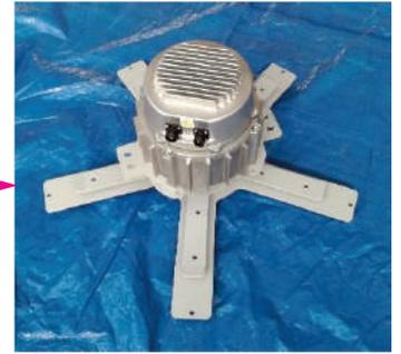
Para montar el soporte es necesario rotar el motor apoyándolo sobre la estrella. Coloque el soporte sobre el motor para centrar los orificios en la placa anticaída.
