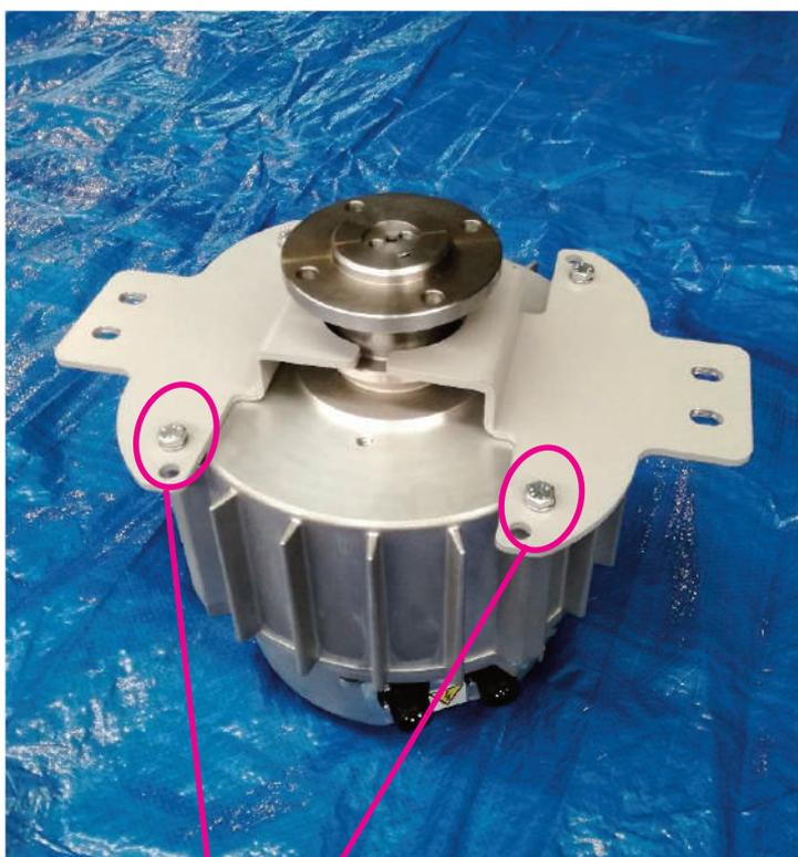
Retirar los tornillos que fijan la placa anticaída al motor
