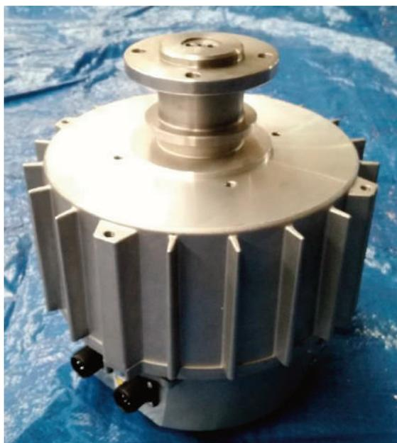
Inserte el buje en el eje en la dirección indicada en las imágenes; la parte cilíndrica más estrecha debe encajar en el motor.
