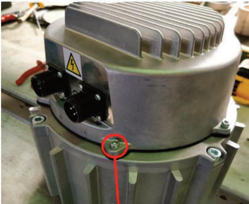
Desatornillar los 6 tornillos M5
