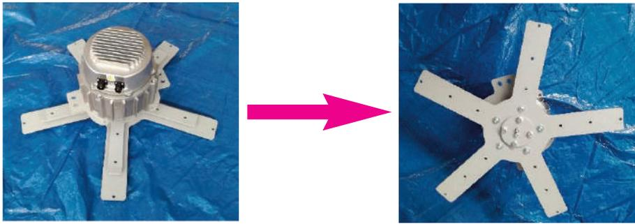
Antes de continuar, ponga el motor inverter al revés para tener la estrella de fijación de las palas en el lado superior.
