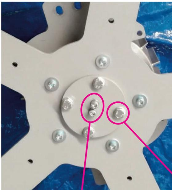
Retirar los tornillos que unen el disco al eje del motor
